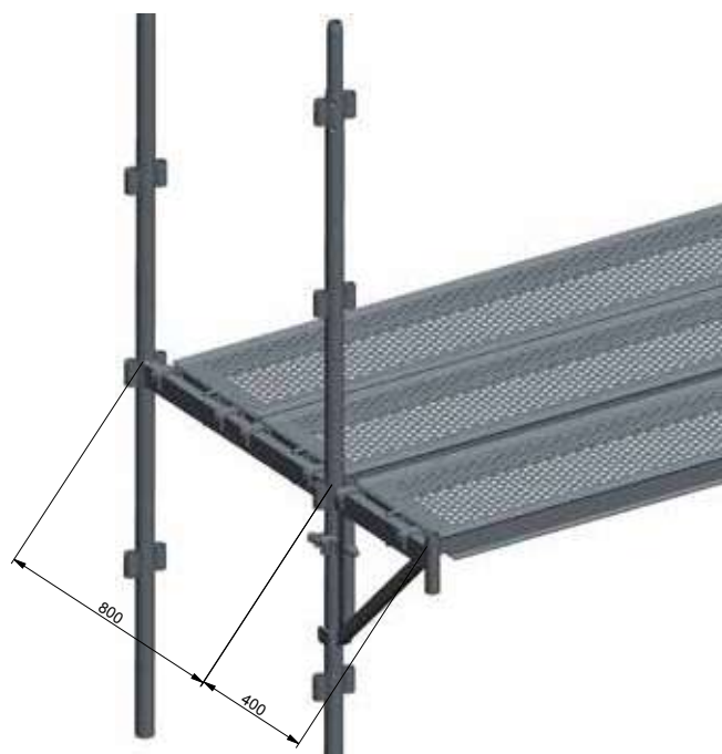
2 planchers de 365 mm + 1 de 365 mm ou 1 de 750 mm + 1 de 365 mm sur une échelle en H de 2 m + 1 déport universel
