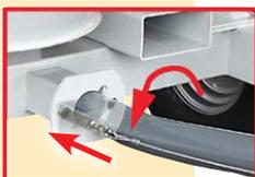
Dispositif d'attelage "Sécurité" breveté. Homologué par l'UTAC suivant le règlement 55 de la CEE-ONU - **Brevet ALTRAD.**
