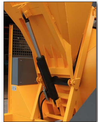
Vérin double effet avec clapet de sécurité bloquant le chargeur en toute position même dans le cas de rupture du circuit hydraulique.
